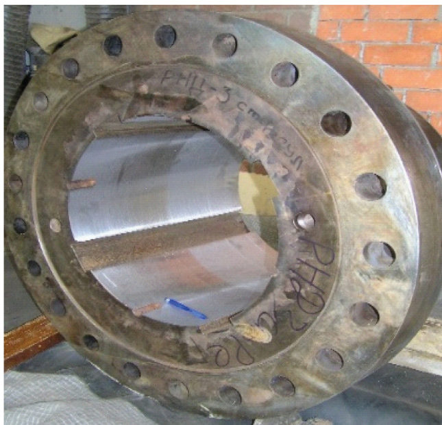
Рис. 2. Восстановление ООО «ТСП» полумуфты ротора турбины К-800-23,5 Пермской ГРЭС (вес полумуфты свыше 1500 кг) методом плазменного напыления по заказу ОАО «Уралэнергоремонт».
