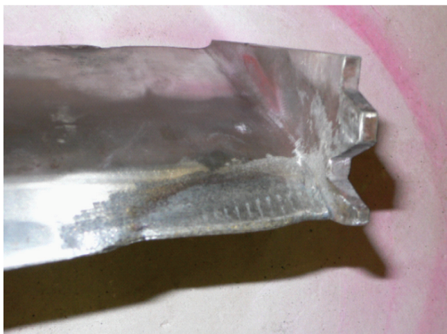
Рис. 3. Восстановление ООО «ТСП» методом плазменного напыления геометрии лопатки и последующей лазерной наплавкой порошкового стеллита на входные кромки РЛ (материал лопатки — ЭИ-961, профиль лопатки 1400) последней ступени паровой турбины К-300.
